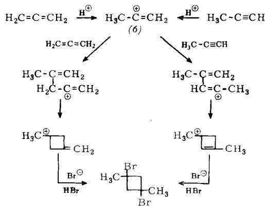
Die Ergebnisse zeigen, daß die elektrophile Addition von Bromwasserstoff an Methylacetylen durch die klassischen Vorstellungen nicht vollständig beschrieben werden kann. Der Schlüssel zum Verständnis der hier und bei der HBr-Addition an Allen [1] beobachteten Cyclodimerisierungen scheint in der Natur des intermediär gebildeten Vinylcarboniumions (6) zu liegen [7].
